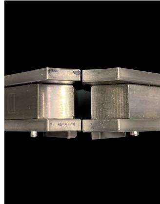
Fixierung im Werkzeug durch federgelagerte Führungen, die beim Schliessvorgang werkstückschonend zurückfedern.
