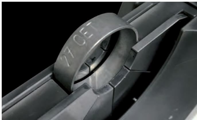
**Fixierung im Werkzeug durch federgelagerte Führungen, die beim Schliessvorgang werkstückschonend zurückfedern.**
