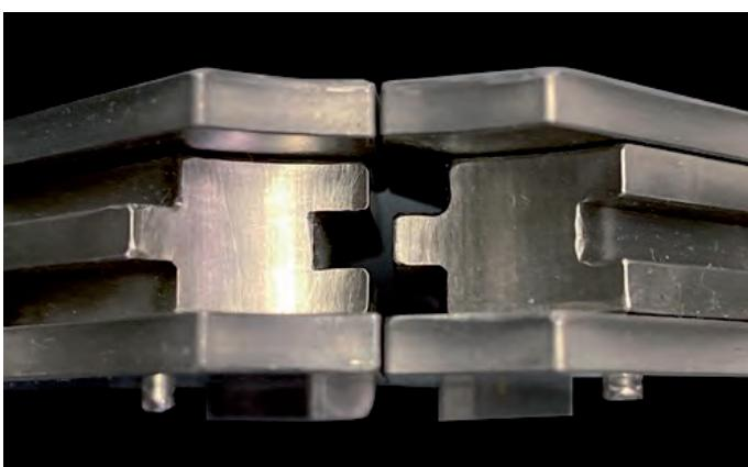
**Werkzeug/Segment überlappend ausgeführt**
